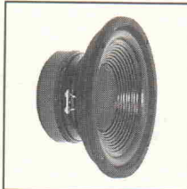
Neu: WSP 21 S: Tiefton-Lautsprecher in HiFi-Qualität mit Polypropylenmembran, größere Partialschwingungsfreiheit, sehr breitbandig einsetzbar, 100/130 Watt, 20-6000 Hz, 206 mm Ø
