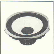
WS 38 AW: HiFi-Tieftöner, Alu-Gußkorb, besonders geeignet für Einbau in Baßreflex-Boxen, 170/230 Watt, 20-3000 Hz, 399 x 399 mm
