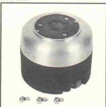
DR 11.13: Professioneller Mittelhochton-Treiber. Sehr ausgeglichener Frequenzgang, 70/100 Watt, 800-20000 Hz, mittl. Kennschalldruck 108 dB/1W/1 m
